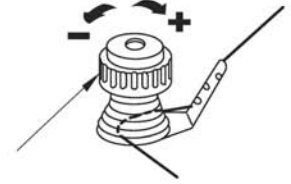
Masura sarmak için ön tansiyon makarasına iplik sarma
