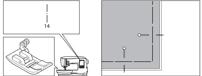
1. Coloque la tela bajo el prensatelas y baje el prensatelas.
