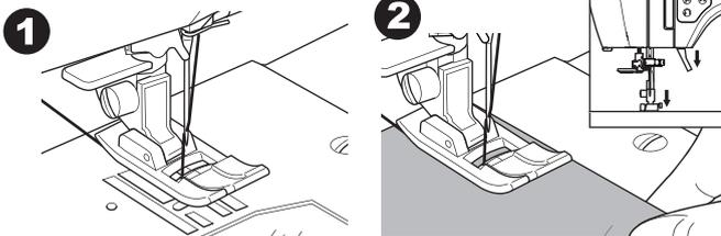
3. Retenez le fil supérieur et appuyer ensuite sur le bouton Marche/Arrêt ou appuyer sur le rhéostat. Continuez à retenir le fil après avoir cousu quelques points. Guidez le tissu légèrement tout en cousant. Vous pouvez ajuster la vitesse de couture en appuyant sur le bouton de Contrôle de la Vitesse ou sur le rhéostat. Ces boutons servent à déterminer la vitesse lorsque vous utilisez le bouton de marche/arrêt et servent aussi à délimiter la vitesse lorsque vous utilisez le rhéostat.
