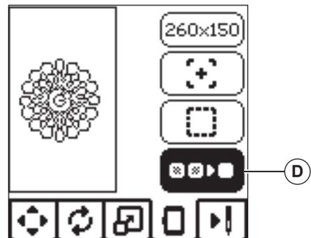
Cuando completa la edición del diseño, presione la pestaña Bordar para iniciar el bordado.
