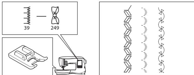
Para personalizar el patrón de puntada decorativa continua, puede ajustar el largo y ancho del patrón. Experimente con pedazos de tela hasta que logre el largo y ancho deseados.
