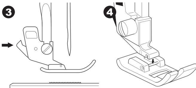
5. Rabaissez le levier du pied presseur et le pied presseur s'enclenchera sur le support du pied.
