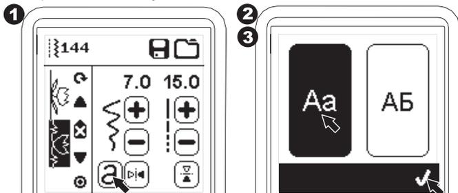
4. Presione la letra deseada directamente. Presione las pestañas de caracteres (abajo de la pantalla) para cambiar a minúsculas, números, etc.
