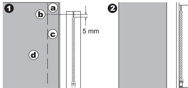
3. Coloque el Pie Pega Cierres. Coloque el lado derecho del perno prensatelas al sujetador del prensatelas cuando cosa el lado derecho del cierre y el lado derecho del perno prensatelas al sujetador cuando cosa el lado izquierdo del cierre.
