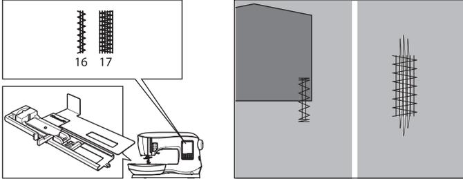
1. Ajuste deslizamiento en la base del Pie de Ojales según el largo del refuerzo o remiendo a coser.
