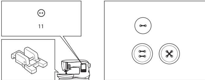
1. Abaissez les griffes d'entrainement en déplaçant le levier d'abaissement des griffes du côté gauche. (Un message apparaîtra lorsque le point No. 11 sera sélectionné, appuyer sur le bouton "✓".)
