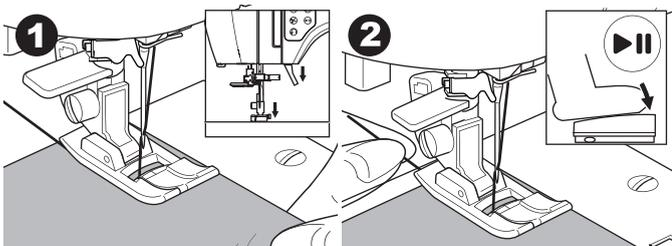
3. Cuando llegue al final de la costura, presione el botón Reversa. La máquina coserá unas puntadas hacia atrás y unas puntadas hacia adelante y se detiene automáticamente.
