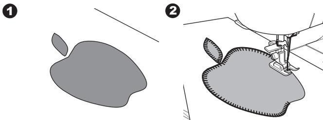
Lorsque vous cousez des angles abruptes ou des courbes, amenez l'aiguille dans sa position la plus basse et soulevez le pied presseur.
