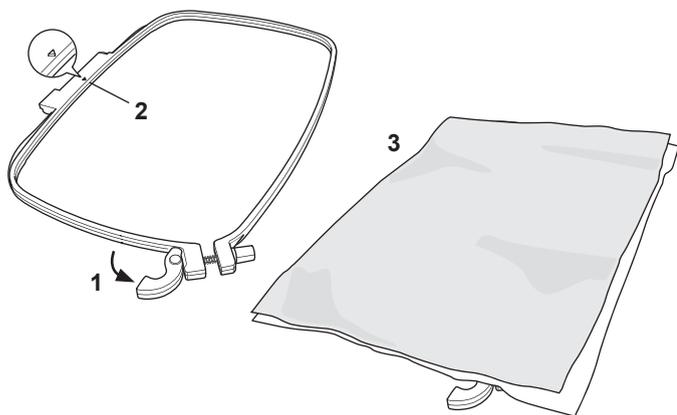
4. Coloque el aro interior en la parte superior de la tela con la flecha en el borde izquierdo y presione en el aro exterior.
