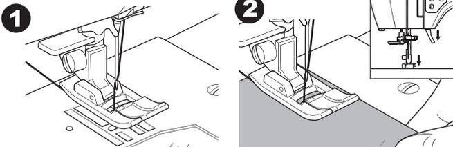
3. Sostenga el hilo superior y presione el botón Inicio/Paro o presione el pedal controlador. Siga sosteniendo el hilo después de coser unas puntadas. Guíe ligeramente la tela mientras cose. Puede regular la velocidad de costura presionando los botones de Control de Velocidad o el pedal controlador. Los botones se usan para ajustar la velocidad cuando se usa el botón Inicio/Paro también la velocidad máxima del pedal.
