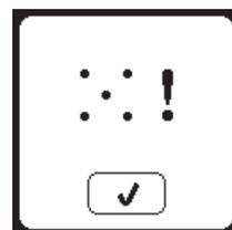
**LA LARGEUR DU POINT EST LIMITÉE POUR L'AIGUILLE DOUBLE**
