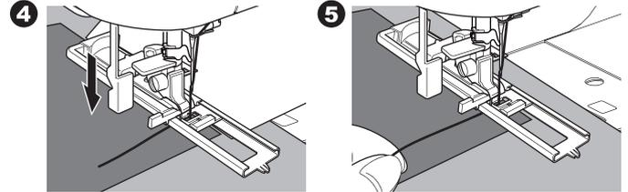
6. La máquina coserá la puntada de refuerzo o zurcido, como se muestra. La máquina se detendrá automáticamente cuando el patrón concluye.
