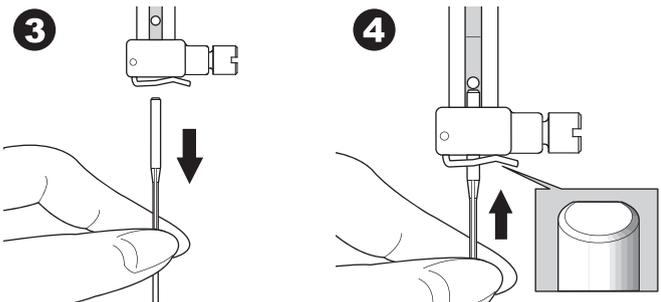
5. Resserrez la vis de l'aiguille. N'utilisez pas une aiguille gauchi ou épointé (a). Placez l'aiguille sur une surface plane pour vous assurer qu'elle soit droite.
