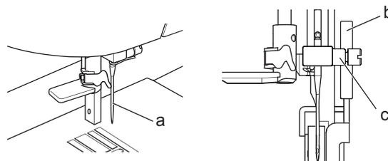
3. Deslice la cabeza sujetadora de su izquierda a la derecha de modo que se coloque en la barra presionadora. Para facilitar el acceso, baje la aguja ligeramente girando el volante hacia usted.
