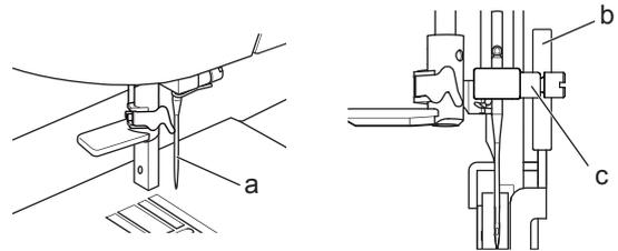
3. Faites glisser la tête de fixation de votre gauche vers la droite de façon à ce qu'il s'attache à la barre du pied presseur.
