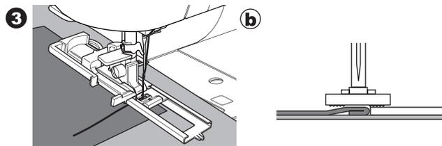
4. Baje la palanca del Ojal completamente.
