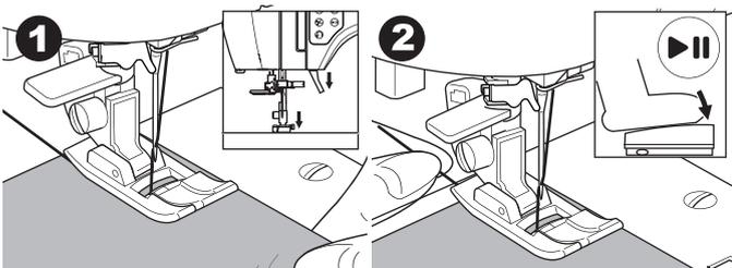
3. Lorsque vous aurez atteint la fin de la couture, appuyez sur le bouton de Marche-arrière. La machine coudra quelques points de reculons et quelques points vers l'avant et s'arrêtera de coudre automatiquement.
