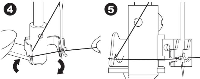
6. Tenez le fil sans serrer et libérez le levier. Alors que l'enfileur pivote à nouveau, la tige à crochet passera à travers le chas de l'aiguille, en formant une boucle de fil.
