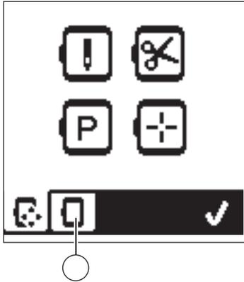
2. Seleccione el aro que desea usar. La lista de aros puede desplazarse presionando los botones de flecha del lado derecho. Sólo aros suficientemente grandes para el diseño seleccionado serán posibles de seleccionar. Aros muy pequeños están marcados con una X y no pueden seleccionarse. El aro seleccionado está marcado con un punto negro.
