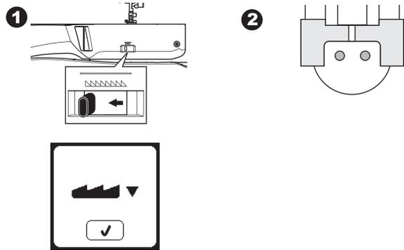
3. Ajuste el ancho puntada de modo que la aguja entre en el orificio izquierdo del botón.
