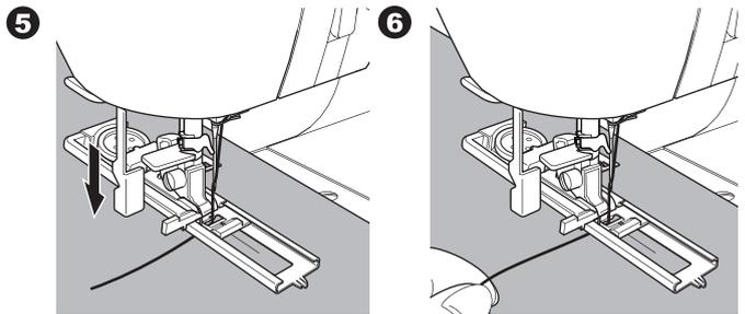
7. La máquina coserá el ojal en el orden mostrado y se detendrá automáticamente después de coser.
