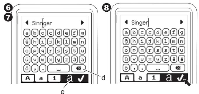
Lorsque vous retournez sur l'écran Séquentiel, les lettres sélectionnées vont apparaître sur le côté gauche de l'écran ACL. Le curseur pourrait disparaître si la longueur de la séquence de lettres est supérieure à la surface indiquée. Voir la page suivante pour comment le déplacer le curseur.
