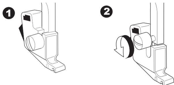
3. Para colocar de nuevo el sujetador, jale el sujetador hacia arriba desde abajo de la barra presionadora.
