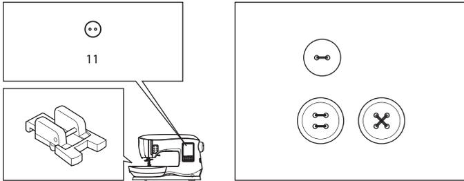
1. Baje los impelentes moviendo la palanca de Avance Inferior a la izquierda (Aparecerá un mensaje cuando seleccione la puntada no. 11, presione la marca "✓".)
