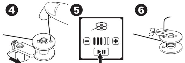
7. Démarrez à nouveau la machine en appuyant sur le bouton Marche/Arrêt à l'écran. Vous pouvez ajuster la vitesse de bobinage en appuyant sur le bouton "+" (plus rapide) ou "-" (plus lent) sur l'écran.
