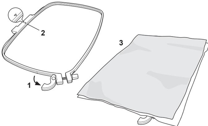
4. Placez le cadre intérieur sur le tissu, avec la petite flèche sur le bord gauche et enfoncez fermement dans le cadre extérieur.
