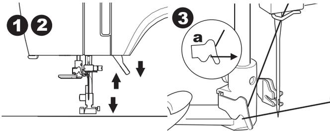
4. Abaissez le levier aussi loin que possible. L'enfileur tournera et le crochet d'enfilage passera au travers du chas de l'aiguille.
