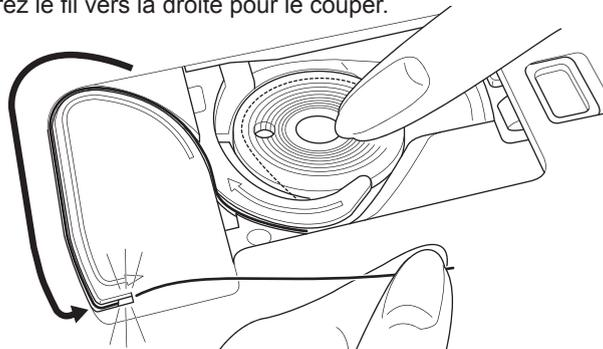
4. Remettez le couvercle de canette en place. Mettez les languettes de gauche dans les trous dans la plaque à aiguille et enfoncez le couvercle de canette jusqu'à ce qu'il clique en place.
